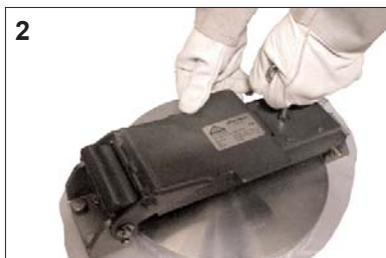
mit der einen Hand den Spannarml greifen und mit der anderen Hand den Vierkantschlüssel um ca. 90° gegen den Uhrzeigersinn drehen.
