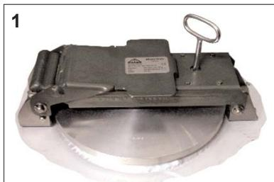
Den Vierkantschlüssel in die Aufnahme des Fallenschlosses stecken,
