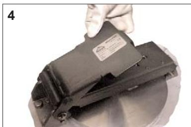
Den Spannarm bis zur Entlastungsstellung anheben, der darunter liegende Druckarm wird entlastet und der Fülllochdeckel löst sich.
